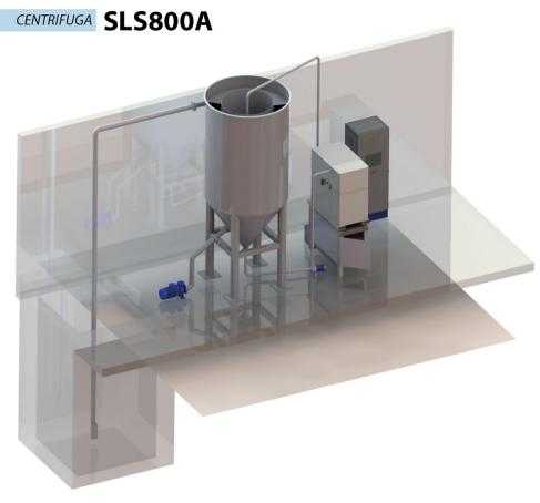
Al suo interno è disposta una centrifuga a scarico automatico e un serbatoio idro-ciclonico che garantiscono una purificazione al 100% dei reflui di molatura del vetro e della pietra garantendo un completo riciclo dell'acqua.
