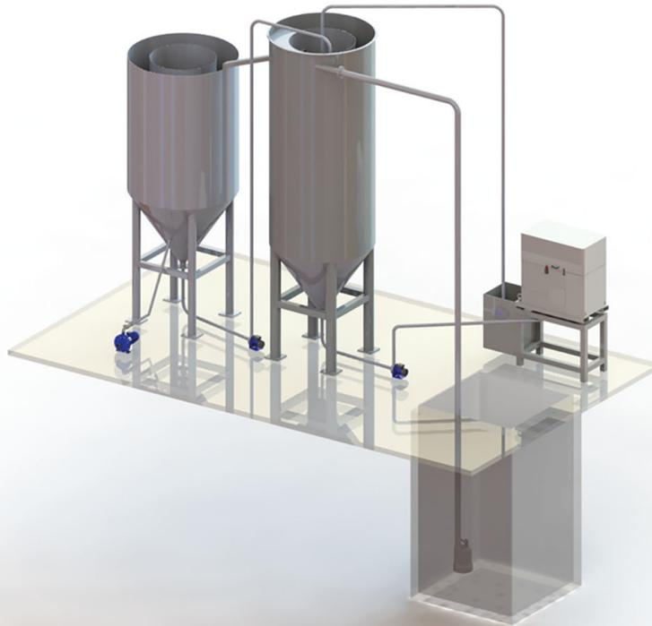
En el interior hay una centrífuga con descarga automática y dos tanques hidrociclónicos que garantizan la depuración del 100% de las aguas residuales de la trituración de vidrio y piedra asegurando un reciclaje completo del agua.
