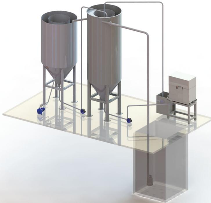
Al suo interno è disposta una centrifuga a scarico automatico e due serbatoi idro-ciclonico che garantiscono una purificazione al 100% dei reflui di molatura del vetro e della pietra garantendo un completo riciclo dell'acqua.
